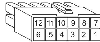
Нумерация выводов со стороны разъёма!
